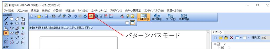
「パターンパスモード」をクリックすると、画面右側にパターン画面が表示されます。クリックすると、クリックしたパターンを開き、その他のパターンは薄線で表示されます。
