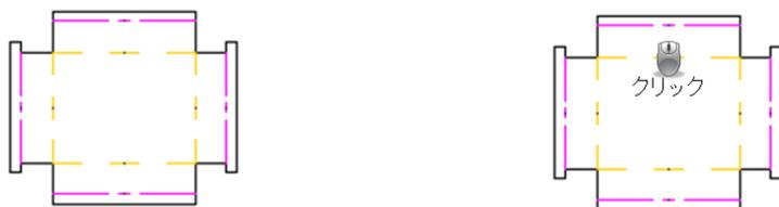
2. 作図位置をクリックすることで、曲げ指示が作成されます。
