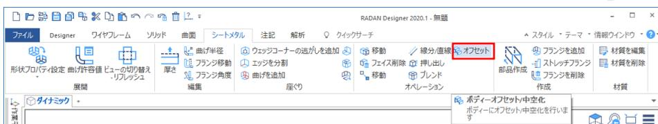
5.モデルを選択して、面を選択します。「シェル」を選択、右クリックで確定になります。
